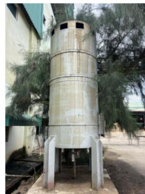
รูปที่ 19 การปิดครอบเครื่องจักรที่มีเสียงดัง
